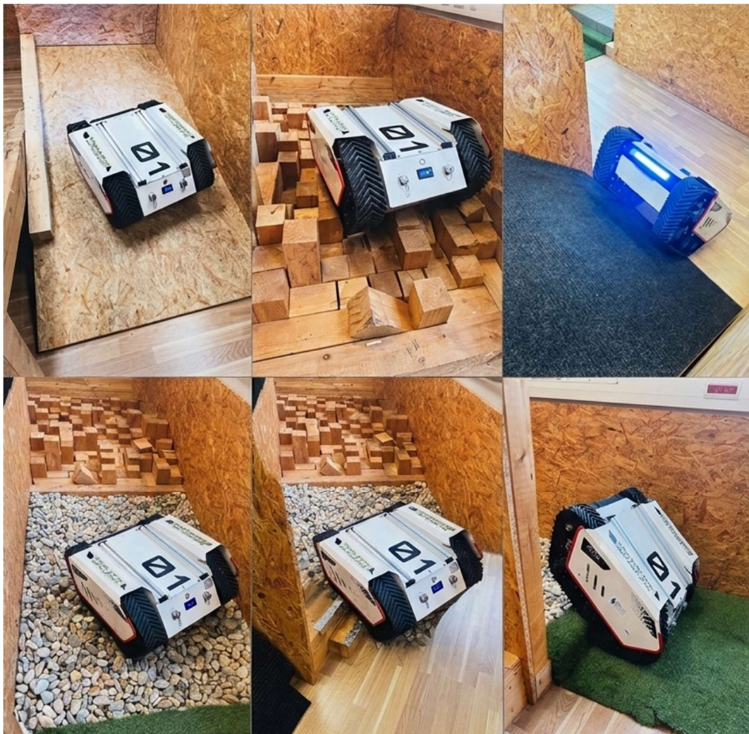
Abbildung 2 Bunker Mini bei den verschiedenen Mobilitätstests an der FH Oberösterreich.
