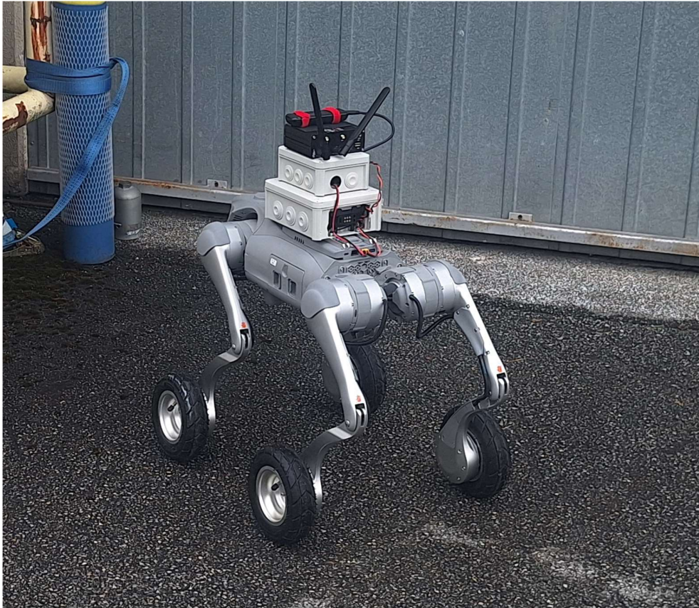
Abbildung 4 Laufroboterplattform Unitree GO2W mit vollständig integrierter Sensorausstattung bei der ersten Feldübung.
