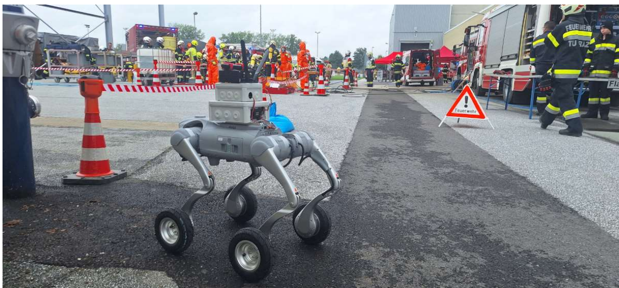
Figure 9 Einsatz des endgültigen integrierten Roboters bei einer Übung mit Gefahrstoffen. In der mittleren Box befindet sich der MultiRAE-Mehrgasdetektor.
