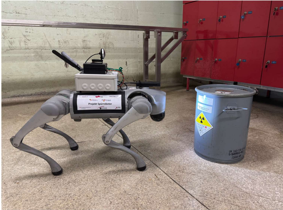
Abbildung 3 Die Laufroboterplattform Unitree GO2 mit initialer Sensorausstattung (ohne Gassensor) während der ersten Testphase.
