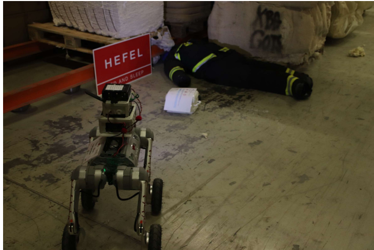
Abbildung 13 Spürroboter bei der Detektion einer Schadstoffquelle und einer vermissten Person bei der Schadstoffübung in Kefermarkt.
