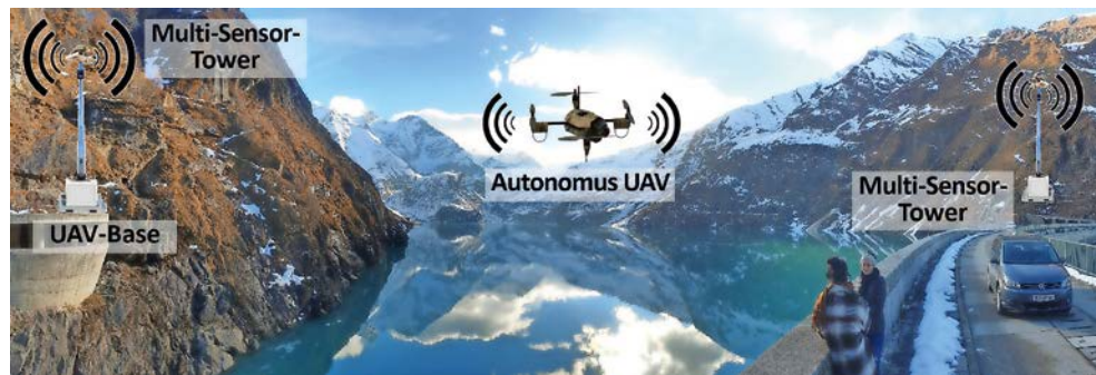
Abb.: Schematische Darstellung des multimodalen mobilen KI-Secure-Konzepts für echtzeitnahe Lagebildgenerierung auf Basis mobiler Multisensormasten und (teil-)autonomer UAVs
