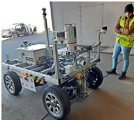
Abb.: Roboter beim Abschlusstest im Straßentunnel am ZaB mit Sichtbehinderung durch Kaltrauch
