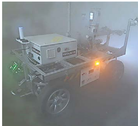
Abb.: Roboter beim Abschlusstest im Straßentunnel am ZaB mit Sichtbehinderung durch Kaltrauch
