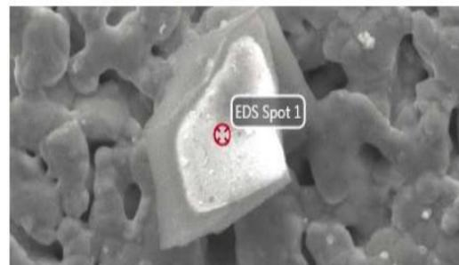
Abb. 6: Ausgewerteter Quarzpartikel auf einem Silberfilter mit oben angeführter Zusammensetzung
